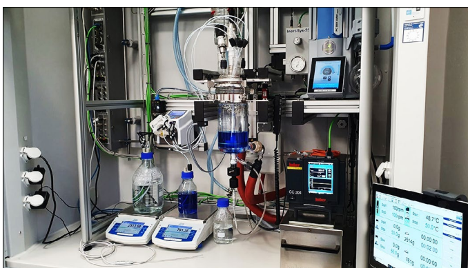
Betriebsbereit und automatisierbar: Die Batch-Anlage im «HiLab». (Bild: HiTec Zang)
